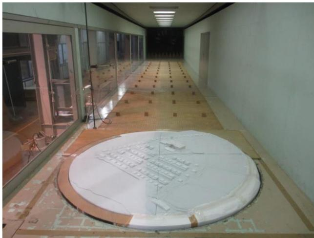
図 1 実験に用いた模型の風洞内の設置状況
