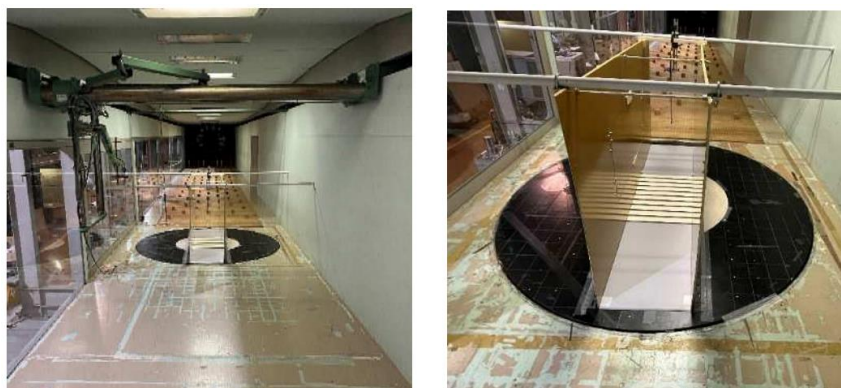
写真1 風洞内模型設置状況
