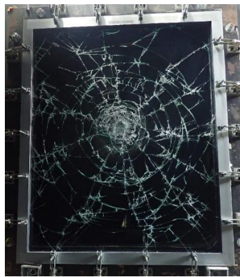
写真 1 ウインドウフィルム貼ガラスの加撃試験後の破損状況
