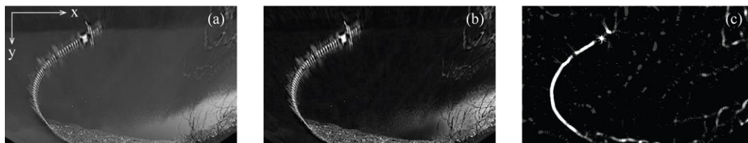
図-2 前処理の過程、(a) グレースケール化・幾何補正後、(b) 大気かすみ除去後、 (c) ガウスイルタ・トップハットフィルタ適用後
